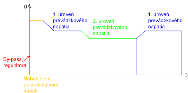
Fig.3. Zmena príkonu v závislosti od napätia
