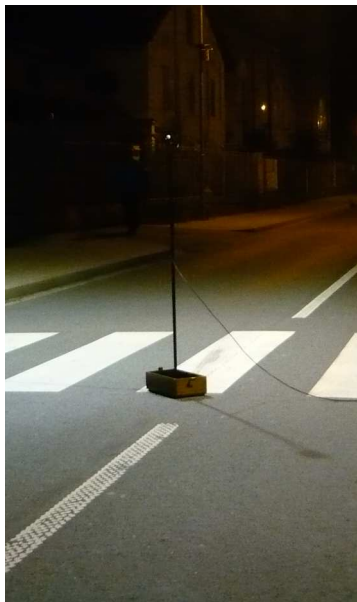
Obr.8. Měření hladin osvětlení ve vertikální rovině – úroveň c)
